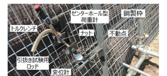
写真2：引抜き試験用ロッド
