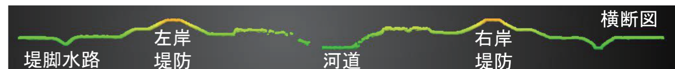
図5：3次元データから得られた河川の横断面図
