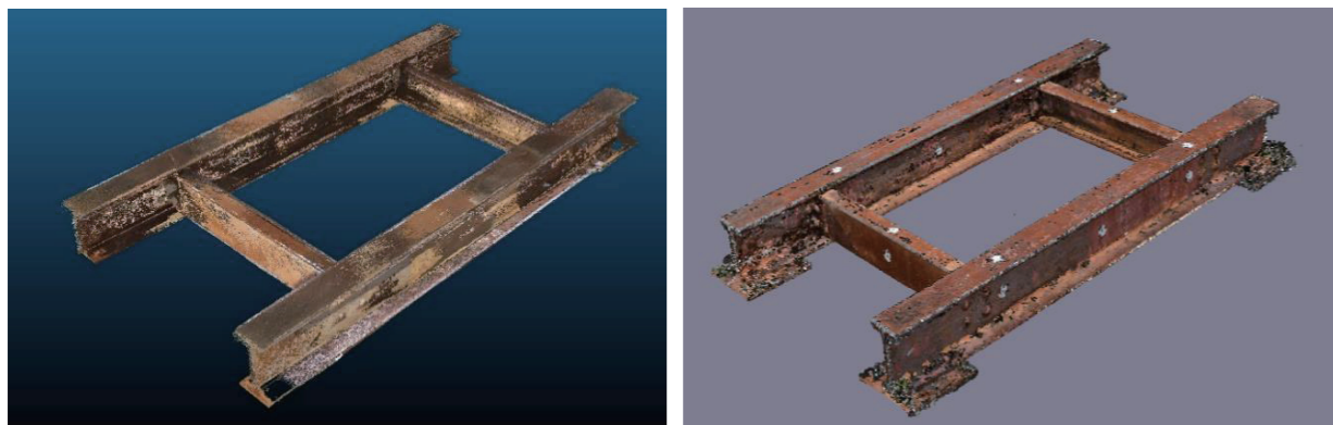
図1：対象建造物の3次元点群モデル(ノイズ除去後)
