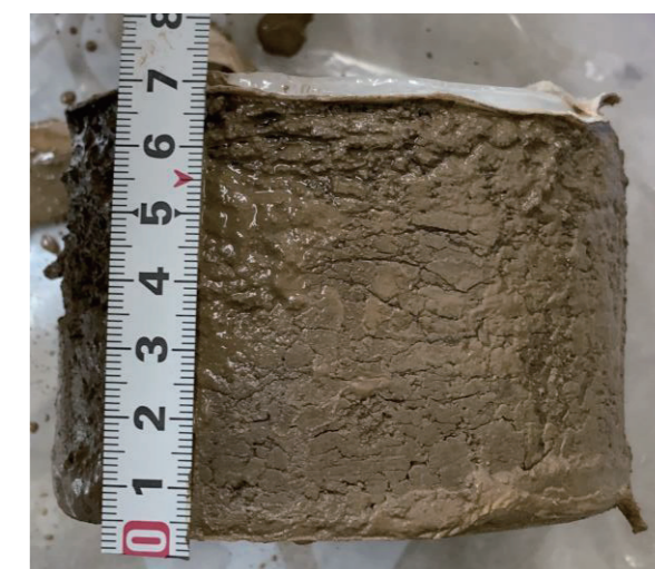
図5：凍上試験後の供試体の様子
