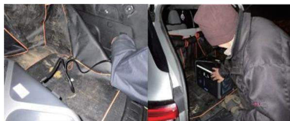
写真1： PHEV からポータブル電源への給電の様子
