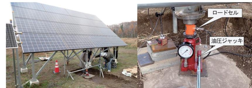
写真2：実物供試体に対するジャッキアップ実験状況
